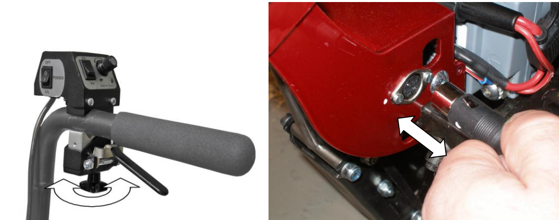
Figur 8: Fastsättning av manöversystemet
