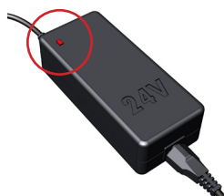
Bateria em carregamento
