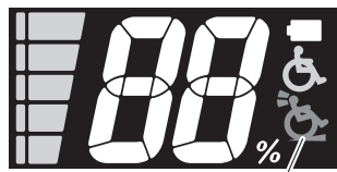
Varningslampan för "indraget tippskydd"
