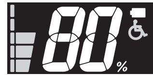
Indikeringslampor för batteriets återstående kapacitet
