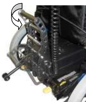
Figur 17: Kobling imellem brug/ikke brug af motor
